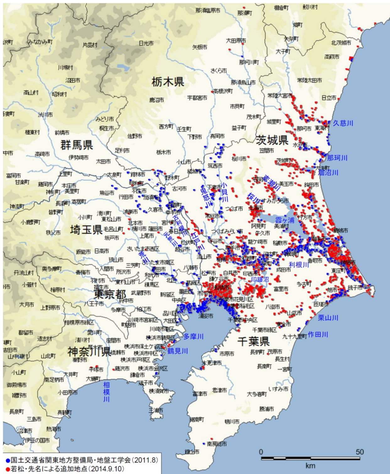
図Ⅱ.2.1-12 東北地方太平洋沖地震により関東地方で液状化が確認された地点の分布（マンホール・管渠の浮き上がり・堤体の液状化のみの地点は含まず。2014.9.10 現在） 若松・先名(2015)
