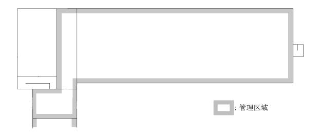
図 3-2 (17) 第二ウラン貯蔵所(2U03)の管理区域 (第二ウラン貯蔵所(2U03) 1 階)
