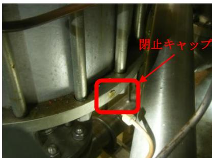
① 圧空供給口への閉止キャップ取り付け及び施錠。
