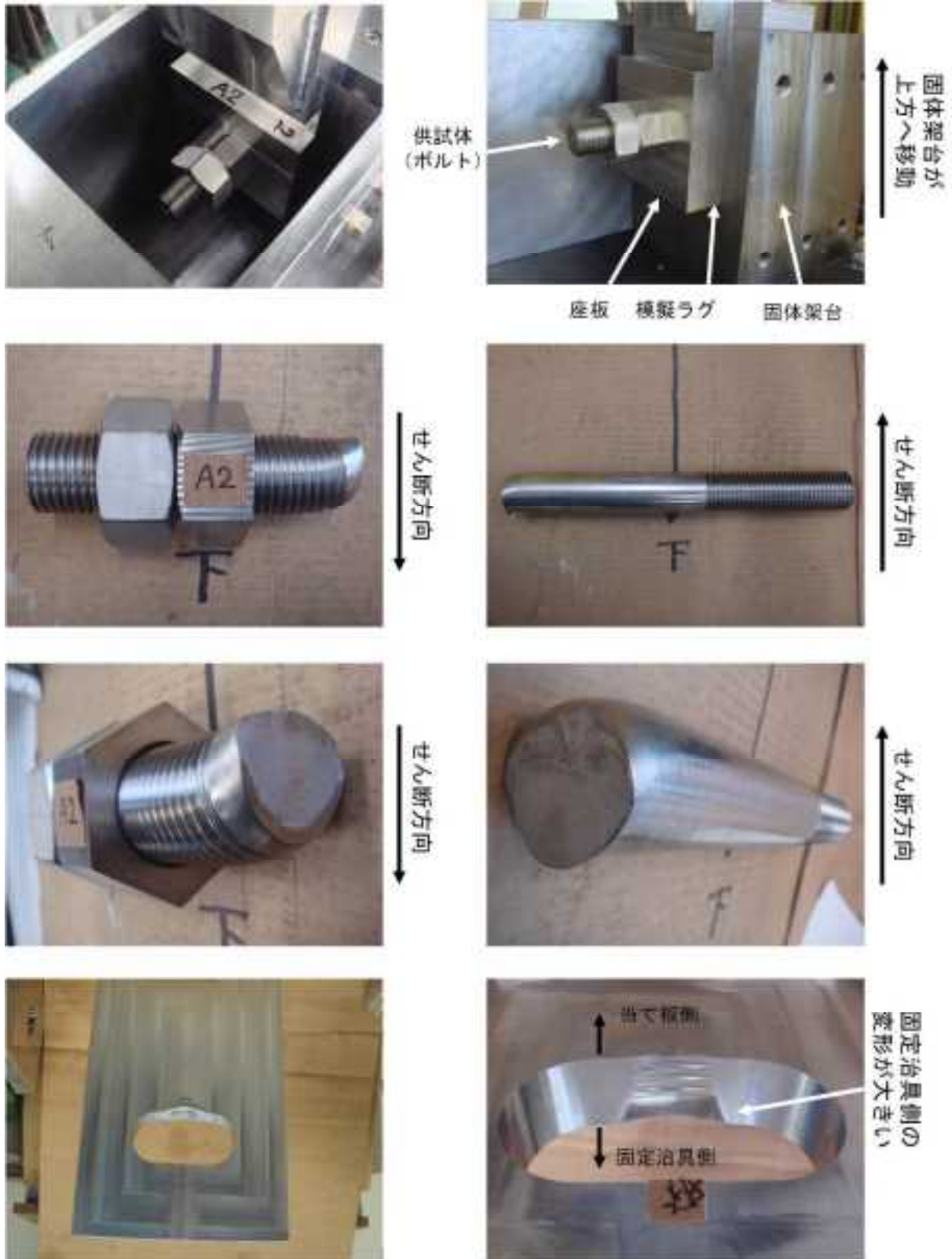
図 4-4 模擬ラグ A (スリット直交) 2 回目試験の試験後の供試体等の状況
