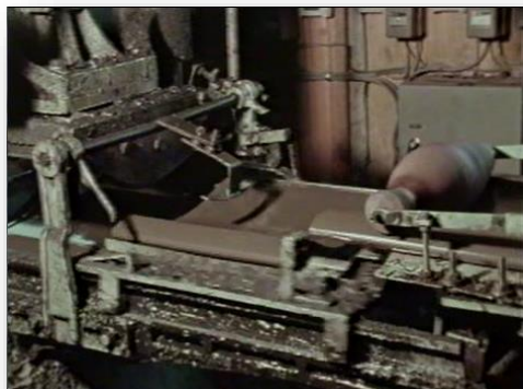
廃泥を利用した瓦の生産
