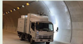
3Dトンネル点検
