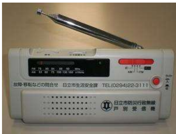
図-6-21.防災行政無線戸別受信機 (日立市 HP より)
