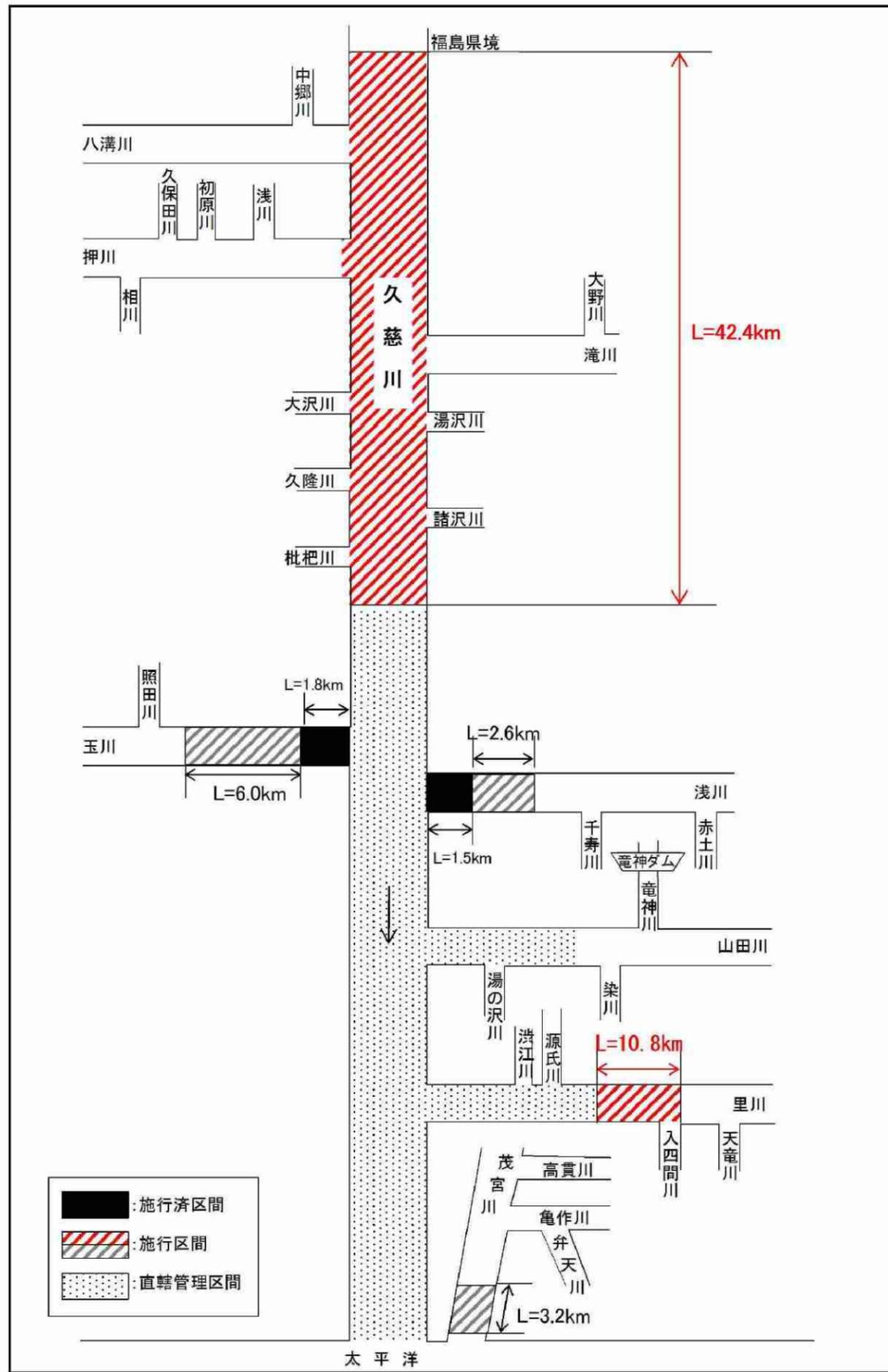
図-2.2 河川工事の施行区間模式図
