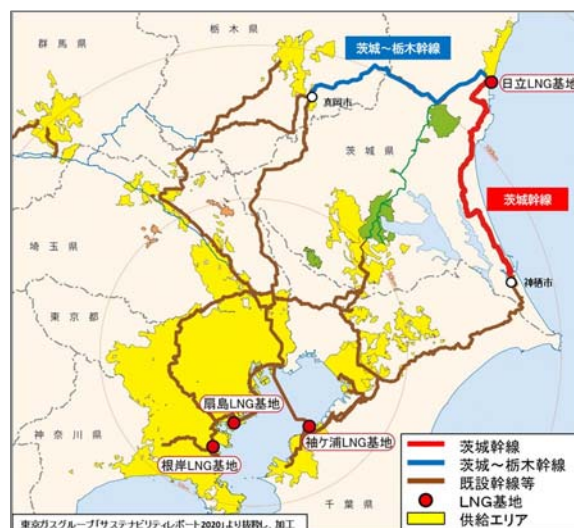
図3-1-1 茨城幹線（ガスパイプライン）概略図
