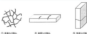
ひび割れの形態例
