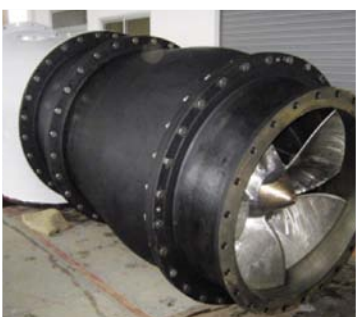
補修により機能回復した排水ポンプ
