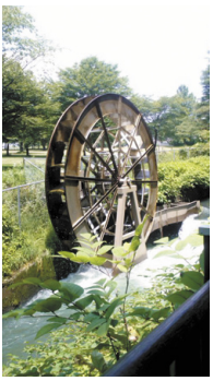
小水力発電の水車(那須野ヶ原用水ウオーターパーク内)
