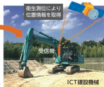
建設現場でのICT活用 位置情報と設計データを基に、建設機械を半自動制御し、施工を効率化
