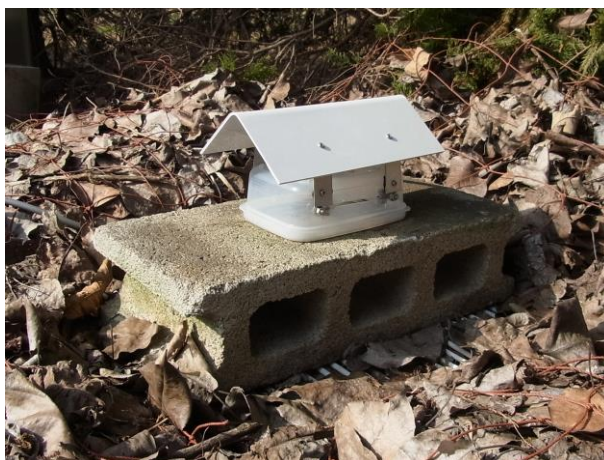
図2 吸引式孢子採集器の設置状況
