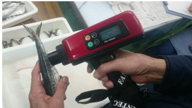
図1 近赤外分光器によるマイワシの簡易脂肪測定
