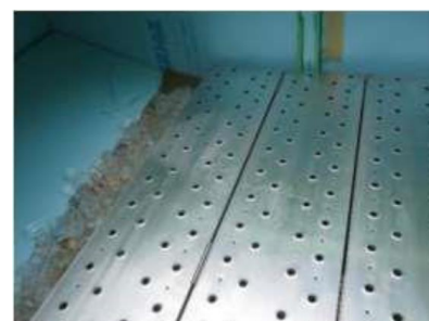
図. アルミ板を用いた効率的な魚倉の保冷
