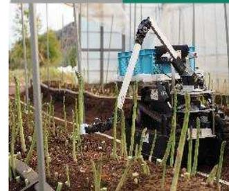
カメラで収穫基準を満たす作物だけを選択し、アームに取り付けられたカッターとハンドで収穫。スマートフォンから予め登録したルートを自動で収穫。
