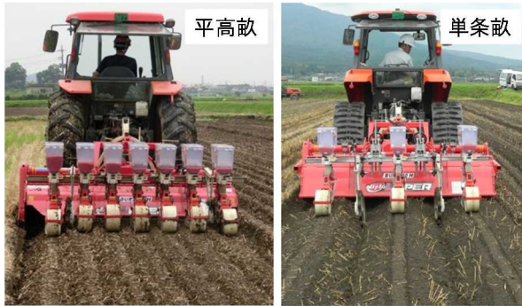
図1 平高畝(左)および単条畝(右)を成形した大豆の耕うん同時畝立て播種作業
