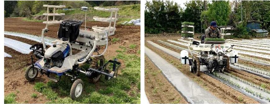
↑ 井関農機(株)製半自動移植機「ナウエルナナ」キク専用モデル(左)と小ギク苗定植作業の様子(右)
