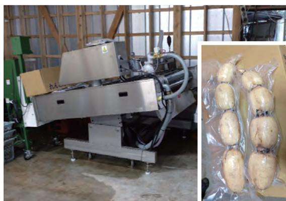
写真1 レンコンの真空包装機（左）と試作品（右）
