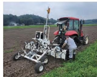
写真4 レーザーレベラーによるほ場の傾斜化
