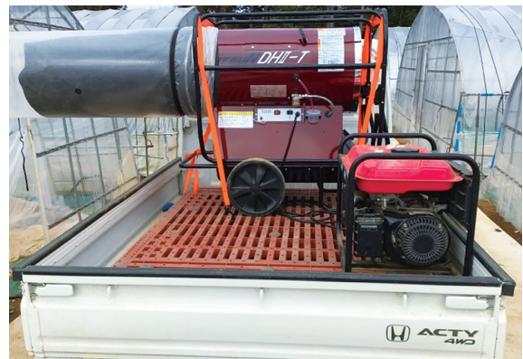
図1 ヒルネット対策に用いたホットガン
