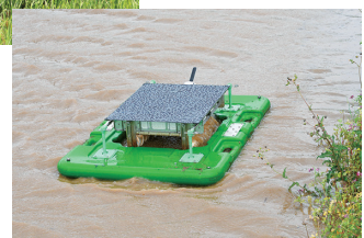
図4 アイガモロボ による雑草の抑制
