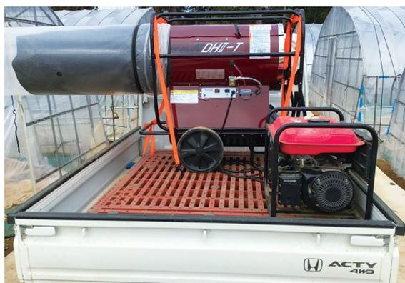
図1 ヒルネット対策に用いたホットガン
