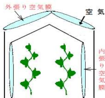
図Ⅱ-2-12 空気膜ハウスの断面図および外観
