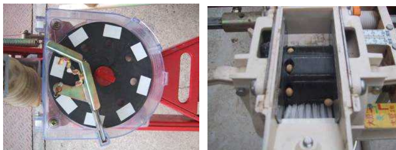
図-III-1-14 傾斜回転目皿式播種機 (左) および横溝ロール式播種機 (右)
