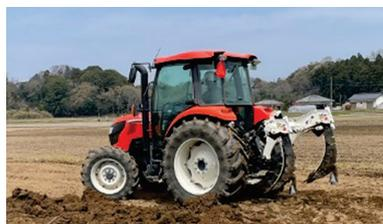
写真2：プラソイラによる耕盤破碎
