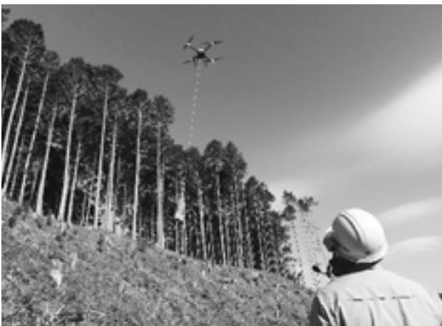
写真-1 ドローンによる苗木運搬
