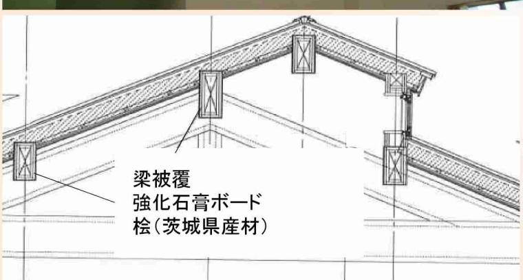
当該施設は耐火建築物とする必要があり、木造梁トラスのままでは不可となる。木造梁トラスは施設のデザイン及び木材を感じられる空間作りの重要なポイントであるため、生かしつつ耐火基準をクリアするための工夫が必要である。そのため、梁トラスを構成する部材を各々耐火ボードで被覆した上にヒノキの無垢材を貼り付けることで耐火基準をクリアし、かつ、木材を感じる空間を作ることができた。
