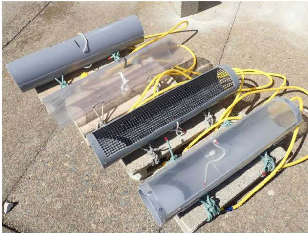
図1 試験に用いた4タイプの放流器. 左上から右下に向かって順に、塩ビパイプ未加工型、透明パイプ型、塩ビパイプトリカルネット型、塩ビパイプ透明フィルム型.
