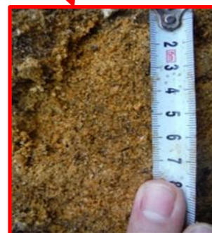
平均最大粒径約3.2mm (上位10個の平均)
