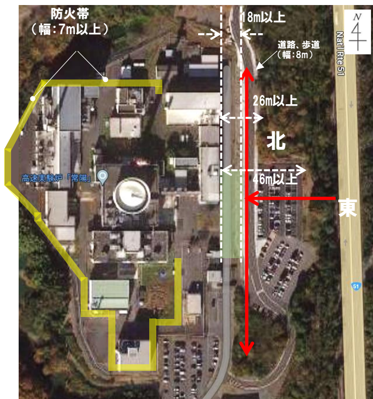
延焼防止対策(防火帯)の概略図
