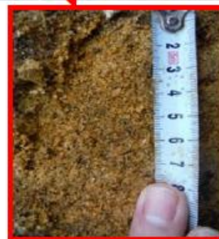
平均最大粒径約3.2mm (上位10個の平均)
