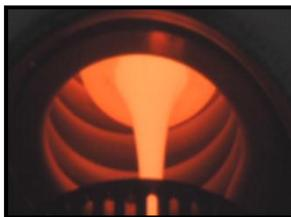
KMOCK\*溶融ガラスの流下状況及びサンプリング状況
