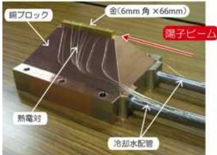
設置前の金標的と冷却用銅ブロック
