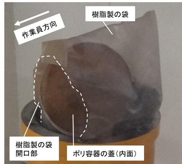
樹脂製の袋の破裂後に作業員が撮影した写真を拡大 (袋の側面の一部分が縦に裂けるように破損)
