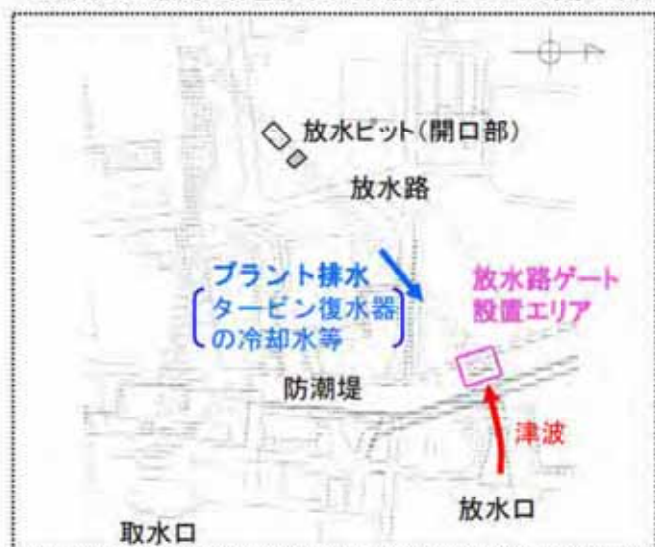
放水路ゲート設置エリア
