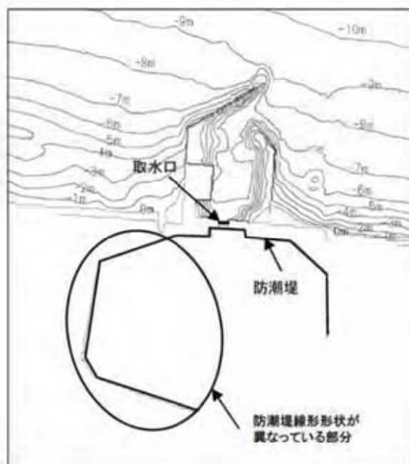
防潮堤設置ルート変更前
