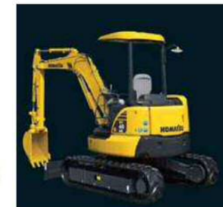
油圧ショベル (自主対策設備) ※ バケット容量: 0.16m 3 最大掘削力: 39kN 配備数: 1台
