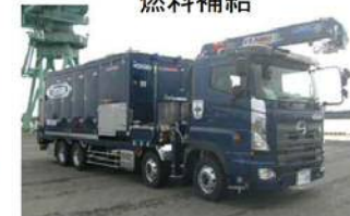
可搬型代替注水大型ポンプ
