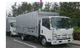
窒素供給装置用電源車
