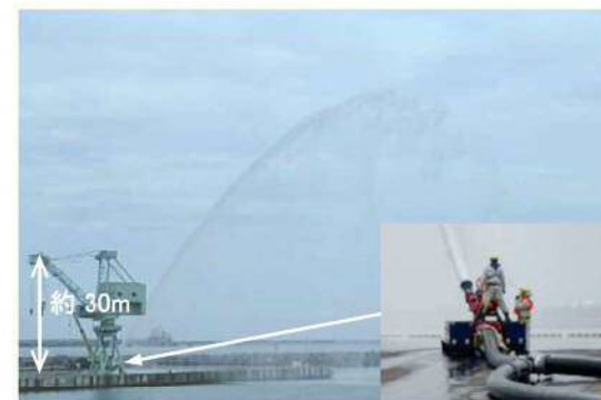
放水実施状況(東海港にて実施) 〔原子炉建屋地上高さ に 放水が到達することを確認〕
