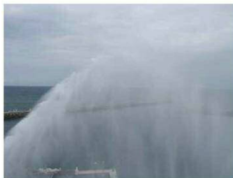
直状放射による放水(到達点での状態)
