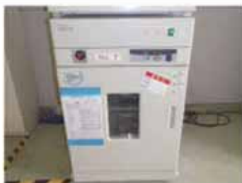
②遮蔽能力の点検状況 (促進乾燥試験)
