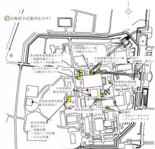
屋外設備の貯蔵箇所
