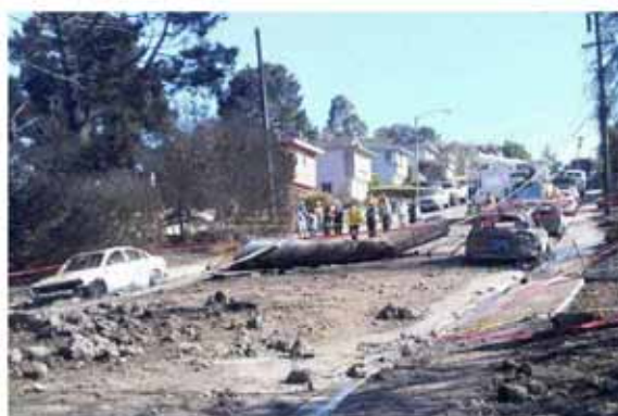
爆発地点のクレーターと破断した配管 外部事象-155
