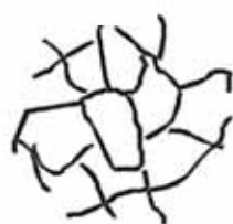
① 表面ひび割れ
