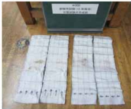
土木シート引張試験供試体(タテ, ヨコ)作成前
