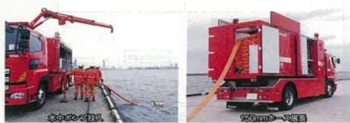
代替海水ポンプの例 (ハイドロサブユニット) ポンプ: 約270m 3 /h、ホース: 約1km
