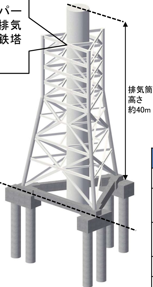
排気筒の支持鉄塔のイメージ
