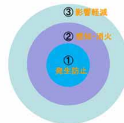
内部火災の深層防護の概念
