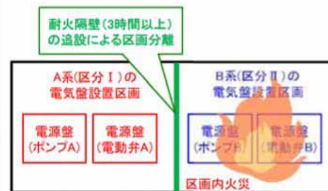
電源盤の系統分離イメージ(例)
