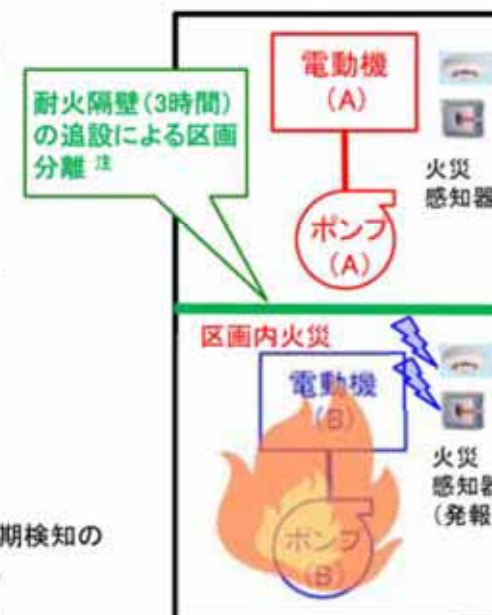
ポンプ・電動機の火災に対する 系統分離イメージ(例)
