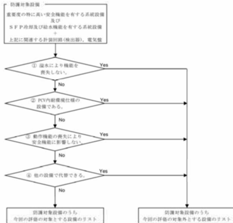
図 防護対象設備のうち溢水影響評価対象の選定フロー
