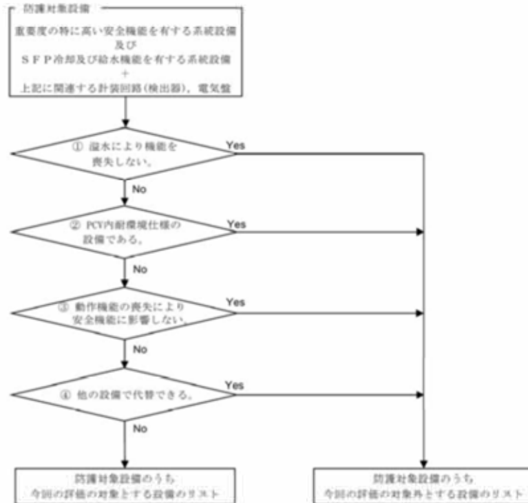
図2.1 防護対象設備のうち溢水影響評価対象の選定フロー
