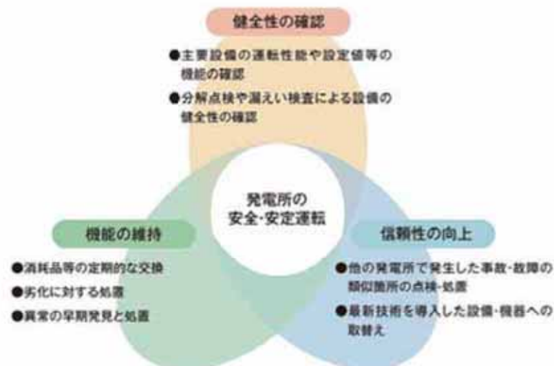
原子力発電所の定期検査の目的
