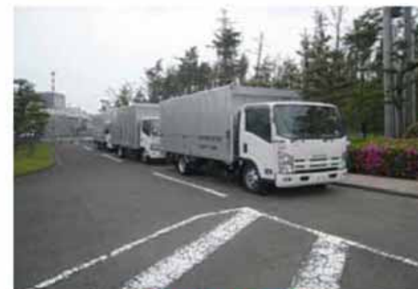
可搬型代替低圧電源車
