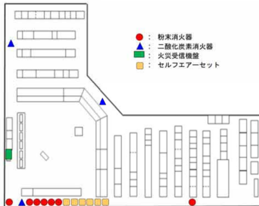
中央制御室内の消火器・防護具等配備状況
