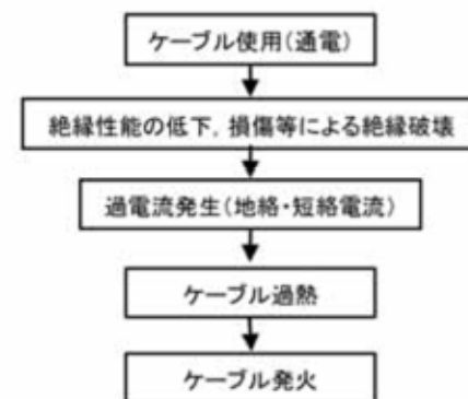
【絶縁性能の低下によるケーブル発火メカニズム】
