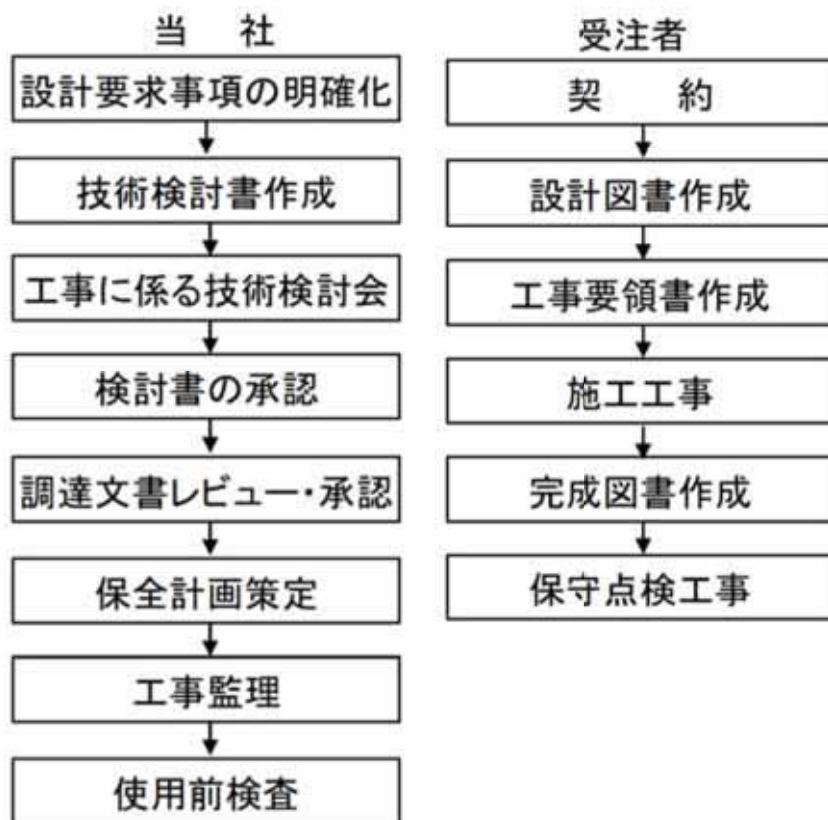
当社及び受注者の工事に係る主な対応項目 (防火シート施工の具体的内容は次頁)
