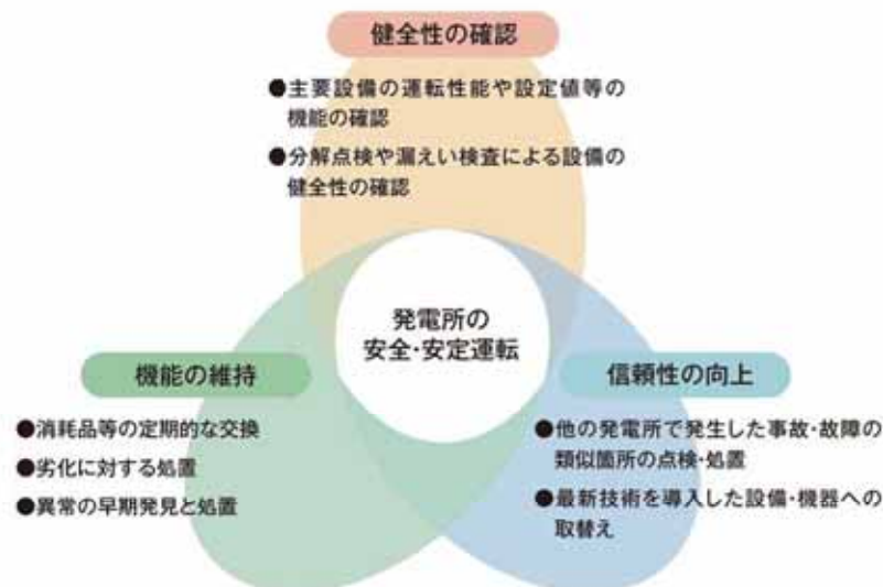
原子力発電所の定期検査の目的
