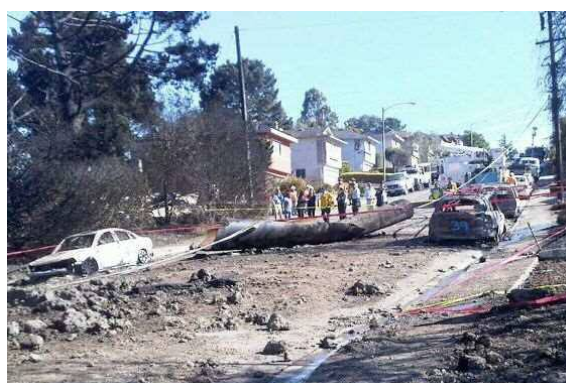
爆発地点のクレーターと破断した配管 外部事象-160
